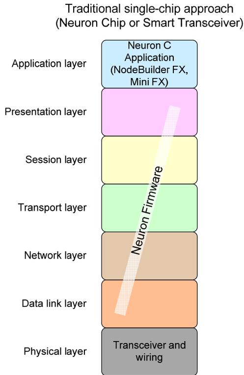
**Figure 1.** A Single-Chip LONWORKS Device
